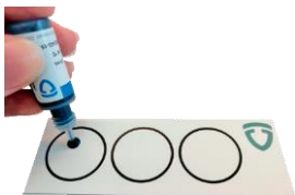
Figura 3. Cómo aplicar la solución de látex.
